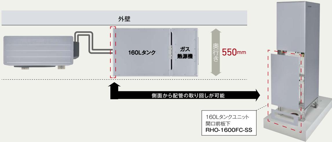
**100L** 設置タイプ・レイアウトによるタンク配管カバー選定
