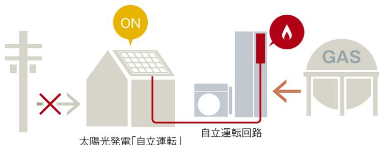
※リモコンで緊急時対応モード「ガス」に設定します。
