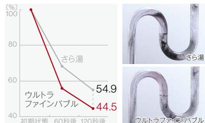
【実験方法】排水管に疑似汚れを溜め、流量7L/分で通水。【実験条件】試験水：水道水、水温：40℃、水圧：200kPa、配管長さ：13A-10mの条件で生成したウルトラファインバブル入りの水を使用。当社調べ。
