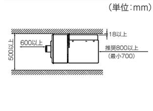
※ 燃焼排ガスが室内に入らずにそのための開口部がないことが必要です。詳しくは熱源機の設置工事説明書をご覧ください。
