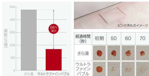
【実験方法】赤色酵母のピンク汚れ(Rhodotorula(ロドトルラ) sp. [KSS-0802])をサンプルに塗布し、10L/分、1分の条件で試験水を流水。その後、サンプルの残存菌数を測定。【実験条件】試験水:水道水、水温:40℃、環境条件:25℃雰囲気、水圧:200kPa、配管長さ:13A-4m。高知工業高等専門学校 秦隆志教授、西内悠介教授、およびリンナイによる検証結果。
