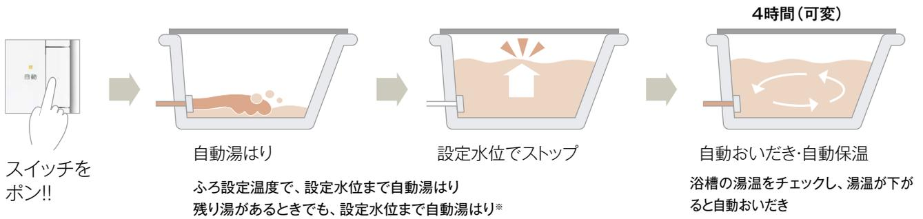
●自動保温は、約30分(気温によって時間が変化します)ごとにお湯の温度をチェックします。また、4→2→1→0→8→6時間の切替えて時間設定が可能。
