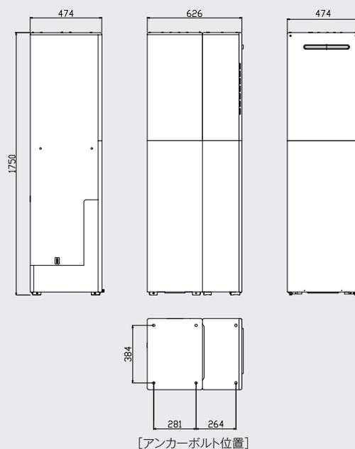
【熱源機・タンク一体タイプ狭小設置】 ガス熱源機に対してタンクが左側の場合
